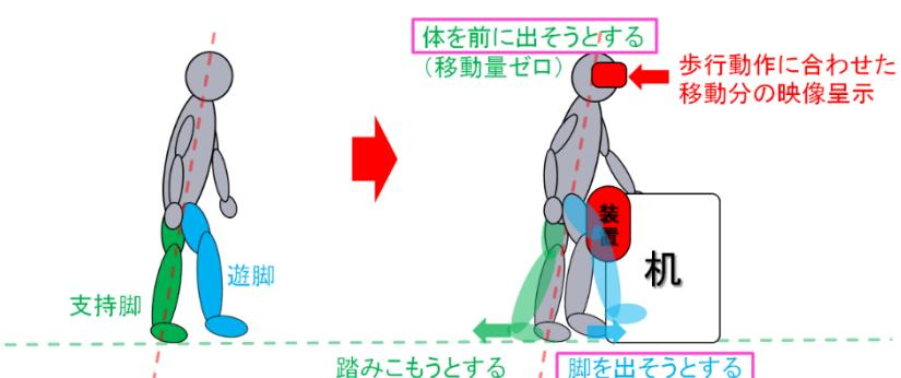
大腿部支持部に載置された荷重センサによって進行方向への歩行動作（体のもたれ具合、足の動き、歩行リズム、歩行バランス等）を推定し、HMD 等の視覚ディスプレイを介して歩行動作に応じた映像を呈示することにより、簡易な仕組みで歩行感覚を定位置で呈示することが可能です。
